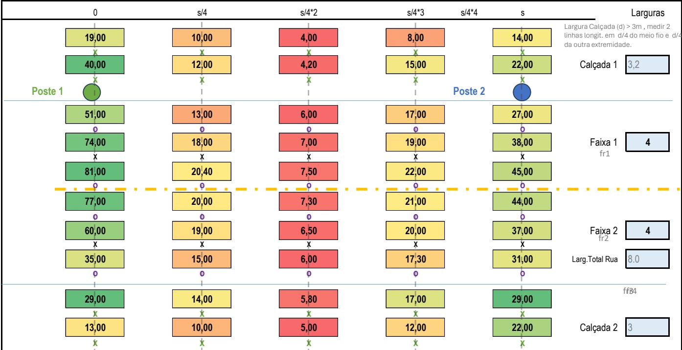
x Medição na linha longitudinal no eixo da calçada
